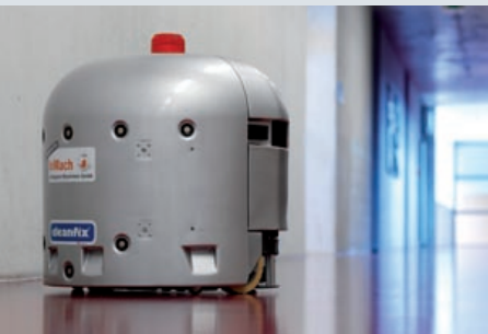
Abb. 6: Der Nasswischroboter Robo 40 besitzt einen RFID-Lesegerät und lokalisiert sich mit dem NaviFloor®.
