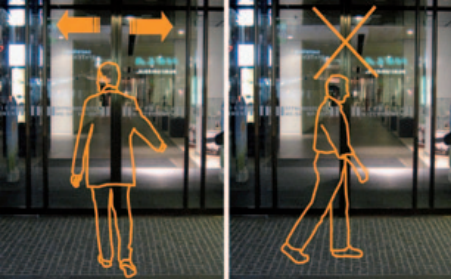
Abb. 4: Eine SensFloor® gesteuerte Tür öffnet sich nur, wenn eine Person direkt auf sie zugeht, geht jemand vorbei oder steht nur davor, bleibt sie geschlossen.
