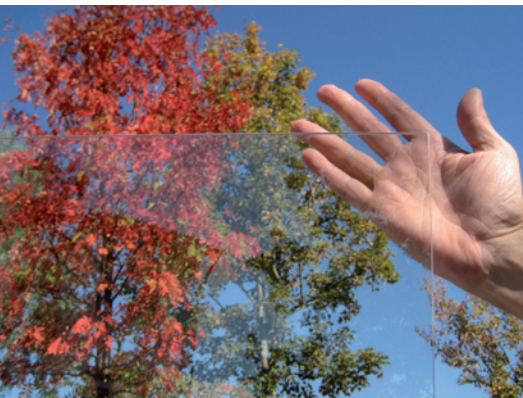
Abbildung 1: SensGlass® mit einer hochtransparenten witterungsbeständigen und leitfähigen Beschichtung macht Glasflächen sensitiv
